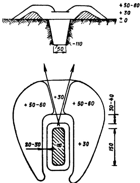
Одиночный окоп для стрельбы с колена и стоя устраивается путем доотрывки в глубину одиночного окопа для стрельбы лежа соответственно до 60 см и 110 см. При отрывке окопа грунт выбрасывается вперед и в стороны, создавая бруствер высотой 40–60 см. В секторе обстрела высота бруствера уменьшается до 30 см, образуя выемку с пологими скатами – открытую бойницу.
